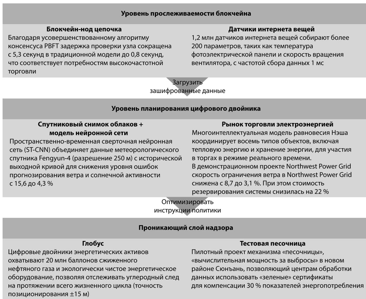
Рис. 1. Синергетическая техническая архитектура для трансграничной интеллектуальной «зеленой» системы управления энергопотреблением
