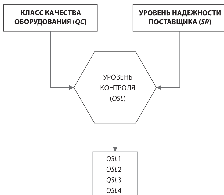
Рис. 3. Схема назначения уровня контроля в зависимости от класса качества поставляемого оборудования и уровня надежности поставщика
